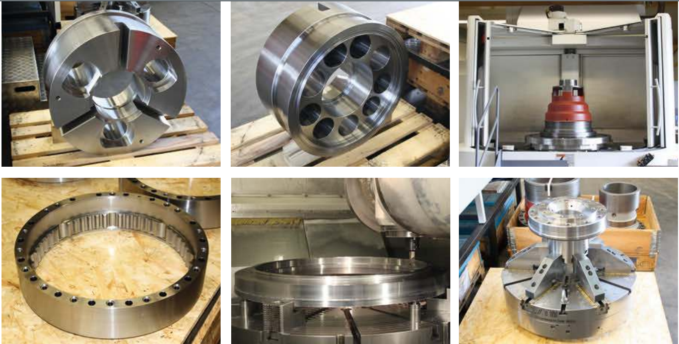
2 Potpourri an hochwertigen und anspruchsvollen Maschinenbauteilen: oben links und Mitte Grundkörper Großfutter, oben rechts Planetenträger, unten links Innenrad, unten Mitte Dichtring und unten rechts eine sogenannte Futterpalette mit Antriebsflansch
