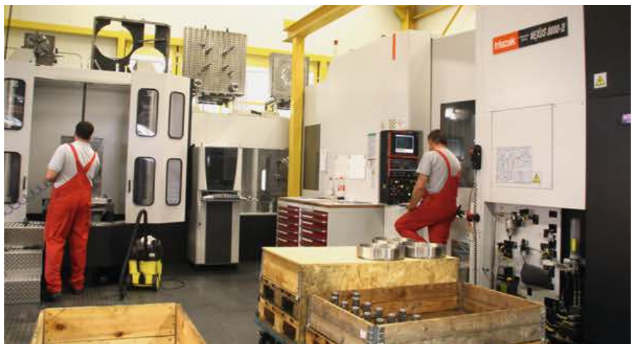
3 Läuft wie ein Uhrwerk: Der Einstieg in die Horizontalbearbeitung in Kombination mit dem modular ausbaufähigen Palletech-System hat sich für ZTM ausbezahlt. An der Be- und Entladestation links werden die Platten hauptzeitparallel ein- und ausgeschleust
